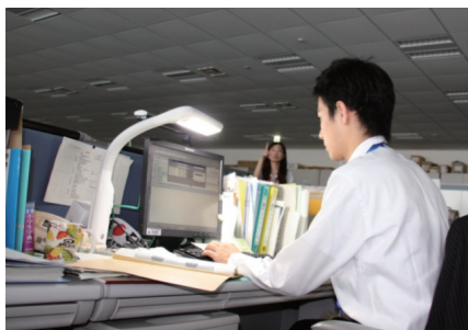
昼休みの消灯(タスク&アンビエント照明の活用)
