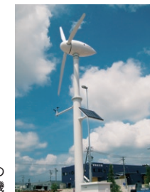
「ららぽーと磐田」の 小型太陽光発電機付き風力発電機
