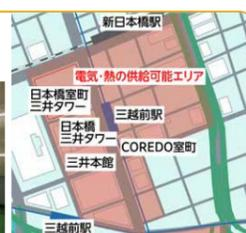
「日本橋室町三井タワー」ではエネルギー安定供給の仕組みとして、東京ガスと共同でクリーンな都市ガスを燃料に電気と熱をつくるガスコージェネレーションシステムを導入。地下に張りめぐらせた自営線を活用し、当該ビルだけでなく周辺エリアにも電気と熱を供給できる、平常時にも非常時にも安心のエネルギーネットワークを構築しました。
