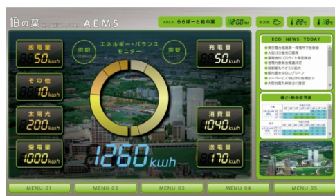
エリア・エネルギー管理システムの モニターイメージ
