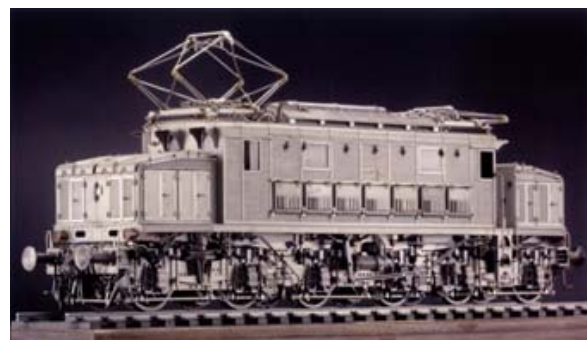
1920 年代のイタリア国鉄（FS）の E626 形式車体のほとんどが洋銀で構成された鉄道模型
