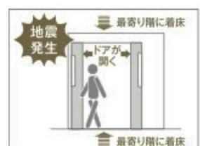
〈地震時管制運転装置付エレベーターイメージ図〉
