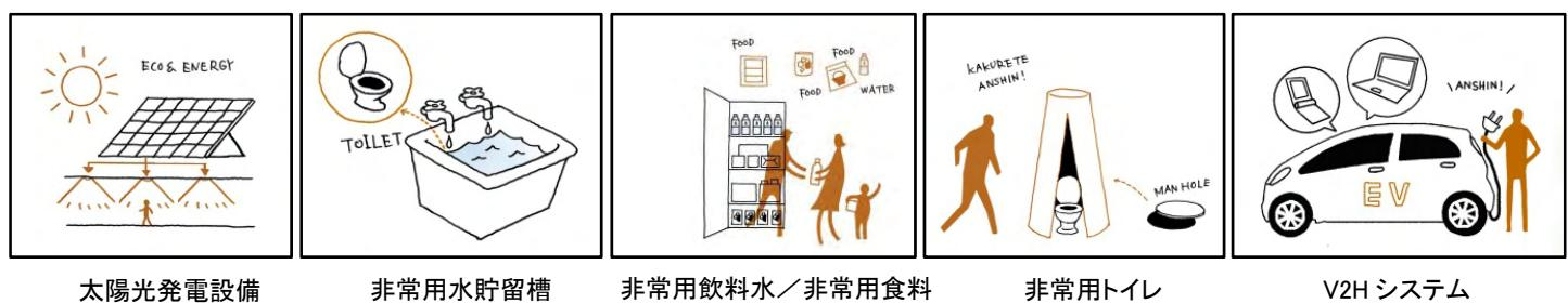
停電対策として、非常用発電機の備蓄燃料増加または太陽光発電設備と非常用蓄電池の標準採用や、カセットガス発電機を設置。断水対策は、飲料水の備蓄やトイレなどの雑水用に非常用貯留槽の設置、非常用トイレ備蓄などを行います。また、ライフラインの配管および排水配管に「可とう継手」を採用し、配管に柔軟性を持たせることで、地盤のずれによる損傷の低減を図ります。
