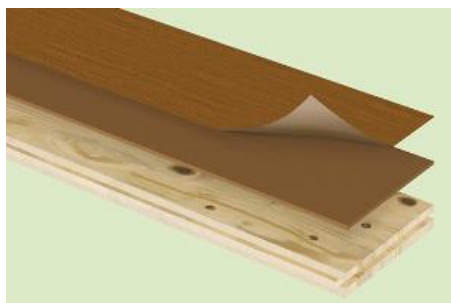
マンションフローリング材の下地
