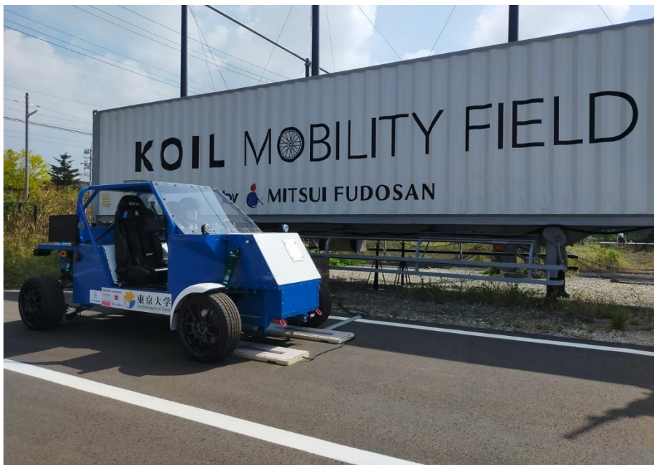
走行中ワイヤレス給電の実証実験の様子
