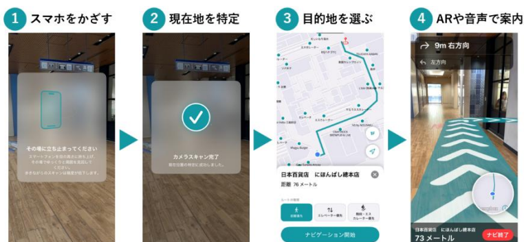
IndoorFlow の利用イメージ。周囲をスキャンし、目的地を設定することで、AR 表示や音声・振動などで案内される
