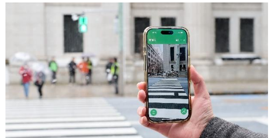
カメラ情報をもとに、AI が信号機の色を判別し、音声で横断可能なタイミングを案内するスマートフォンアプリ
